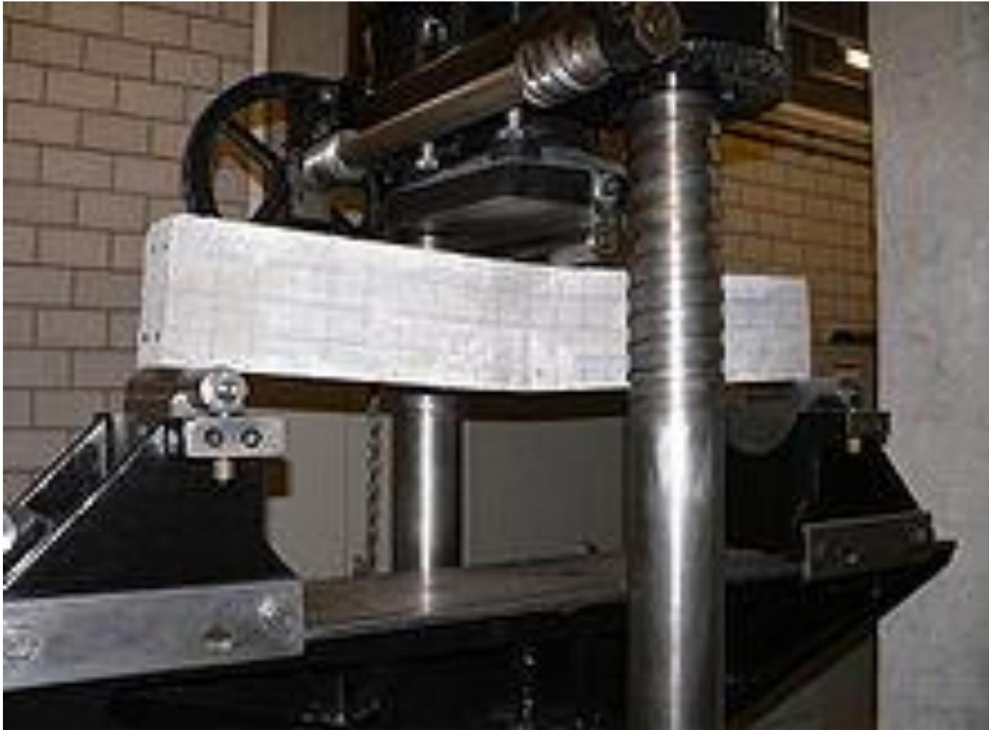
Test de **flexion trois-points** sur un échantillon de **béton**.
